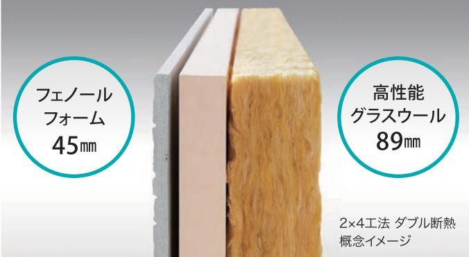
壁の柱の間に断熱材を入れる「内断熱」に壁全体をすっぽり包み込む「外断熱」をプラスした「ダブル断熱工法」。フェノールフォームで外側をすっぽりと包むことで、断熱材が切れ目なく連続するので、構造体部分での温度差が小さくなり、断熱性が更に向上します。
